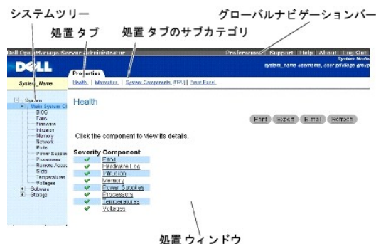
図 3-1 サンプル Server Administrator ホームページ - 非モジュラーシステム
